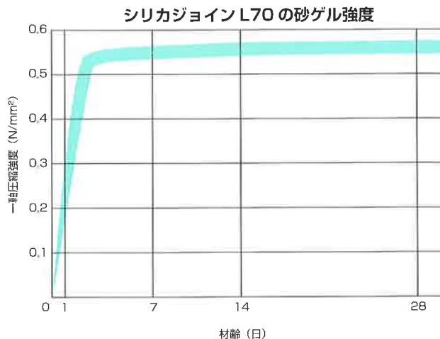
上記ゲルタイムはホモゲルのゲルタイムですが、薬液が地盤に注入されると $\text{Ca}^{2+}$ ・ $\text{Mg}^{2+}$ イオン等によりpHが上昇しゲルタイムは短縮します。そのためサンドゲルでもゲルタイムの確認ができます。
