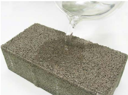
吸水実験。ビーカーから注がれた水を瞬時に吸い込み、スポンジのようにブロック内部に浸透させていきます。
